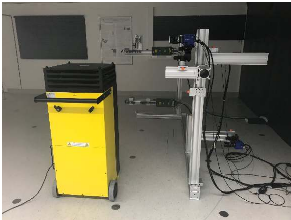
Abbildung 3: Experimenteller Aufbau mit Raumlufthereiniger, zwei Doppelpulslasern und 4 sCMOS Kameras (links) und Aufnahme während der Messung mit PIV (rechts)
